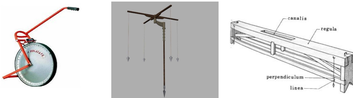
Figura 2: Odômetro, groma e coróbato.
