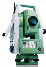
Figura 10: Estação total. Fonte: Abrahão (2012).
